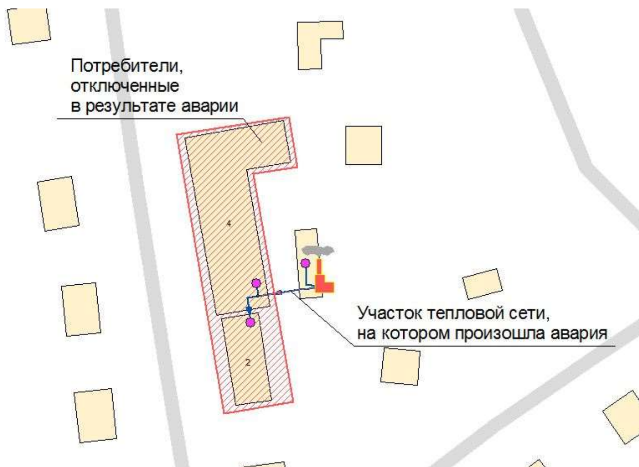
Рисунок 2.11 – Моделирование аварийной ситуации на котельной №19, с. Сугаш
