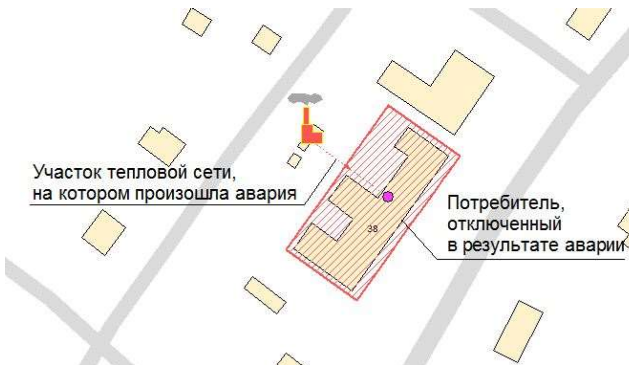
Рисунок 2.10 – Моделирование аварийной ситуации на котельной №18, с. Талда
