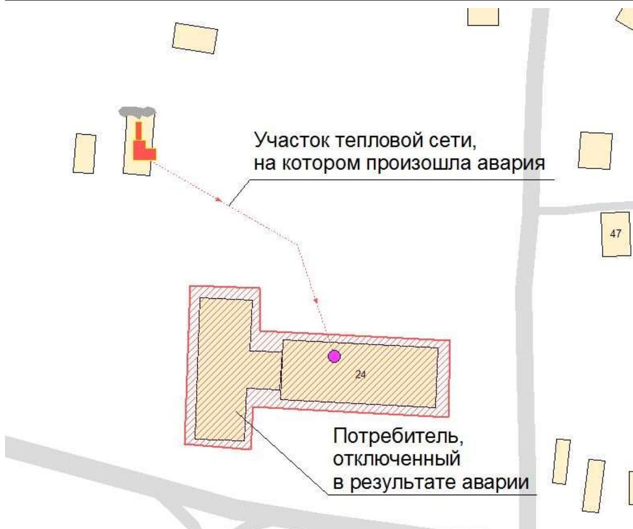
Рисунок 2.11 – Моделирование аварийной ситуации на котельной №12, с. Мульта
