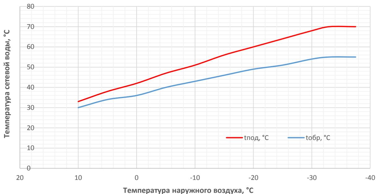
**Рисунок 6.1 – Температурный график тепловой сети от котельных**
